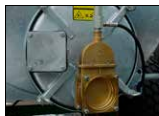
Standard manhole (Ø 600 mm)
